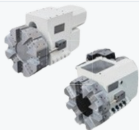
Серія HAK36 — гідравлічна револьверна головка NC
