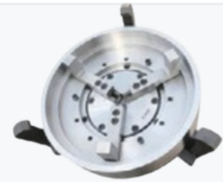
Пневматичний затискний пристрій ступиці фрикційного колеса
