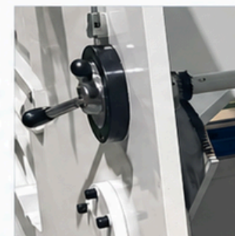
Ручне регулювання зазору ножів
