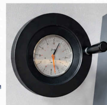
Маховик регулювання зазору ножів
