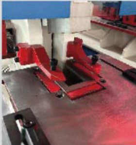
Станція штампового різання
