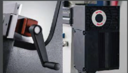
Ручна компенсація прогину Механічна компенсація прогину
