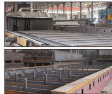
Високотемпературне відпалювання при 600°C для зняття внутрішньої напруги
